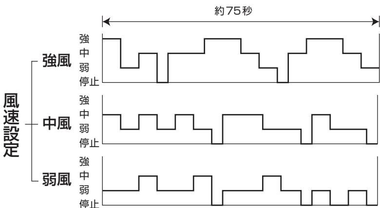
(スリープモード)：本体のON/風量切替(リモコンの風量切替)ボタンで選択した風量の「強」「中」「弱」によって、次の3種類の動作が選べます。タイマー設定と組み合わせて使うと便利です。
