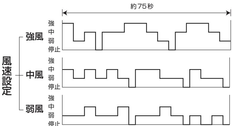
（スリープモード）：風速ボタンの「強」「中」「弱」によって、次の3種類の動作が選べます。タイマー設定と組み合わせて使うと便利です。（表示ランプが暗くなります。）
