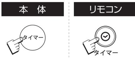
タイマーボタンを押します。押すたびに、本機が自動的に停止する時間が1～7時間の範囲で切り替わります。(設定に応じてタイマーランプが切り替わり点灯します。)
