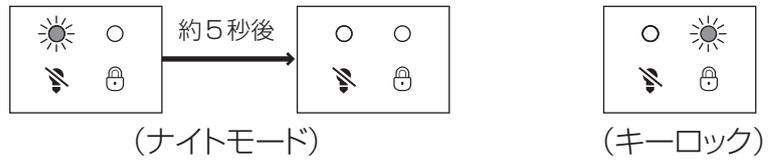
**(ナイトモード)** 就寝時など、ランプの明かりが気になるときにおすすめです。本体のモードボタン、またはリモコンのナイトモードボタンを押すと、ナイトモードランプ以外のランプが消灯し、約5秒経過すると、ナイトモードランプも消灯します。いずれかのボタンを押すと、ナイトモードが解除されます。
