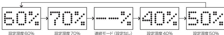
※湿度を50%に設定した場合、周囲の湿度が50%より低いときはミストを発生し、50%に達するとミストの吹出しを自動的に停止します。(湿度センサーを働かせるファンモーターは動作しているため、吹出口からの送風は続きます。) 現在湿度が設定湿度より低くなったとき、ミストの吹出しを自動的に再開します。
