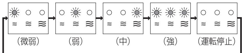
※ファン(上)(下)ボタンで、上下のファンの運転を停止した場合、電源ランプが点灯したままスタンバイ状態になります。再度、ファン(上)(下)ボタンを押すことで、各ファンの運転を個別に再開することができます。
