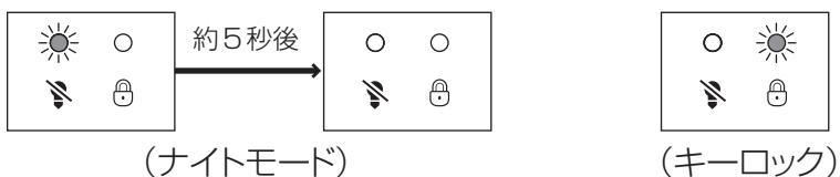
**(ナイトモード)** 就寝時など、ランプの明かりが気になるときにおすすめです。本体のモードボタン、またはリモコンのナイトモードボタンを押すと、ナイトモードランプ以外のランプが消灯し、約5秒経過すると、ナイトモードランプも消灯します。
