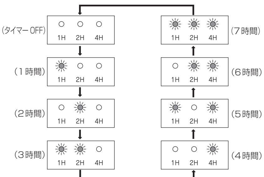
タイマー設定後は経過時間に合わせ、残りの運転時間をタイマーランプでお知らせします。
