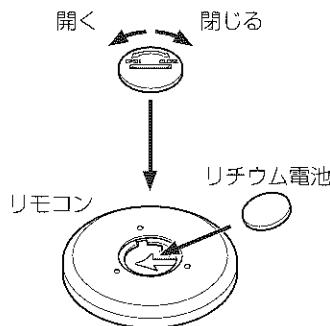
※矢印の方向にリチウム電池を斜めにして、
