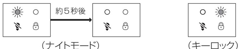
**(ナイトモード)** 就寝時など、ランプの明かりが気になるときにおすすめです。本体のモードボタン、またはリモコンのナイトモードボタンを押すと、ナイトモードランプ以外のランプが消灯し、約5秒経過すると、ナイトモードランプも消灯します。いずれかのボタンを押すと、ナイトモードが解除されます。
