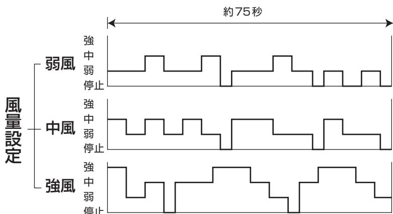
(スリープモード)：風量ボタンで選択した風量の「弱」「中」「強」によって、次の3種類の動作が選べます。タイマー設定と組み合わせて使うと便利です。
