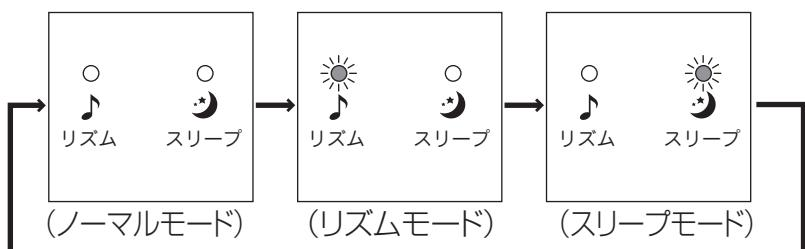
(ノーマルモード)：風量ボタンで選択した風量で動作します。
